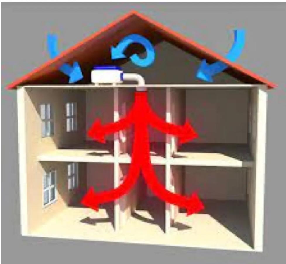
La VCI (La ventilation centralisée par insufflation)
